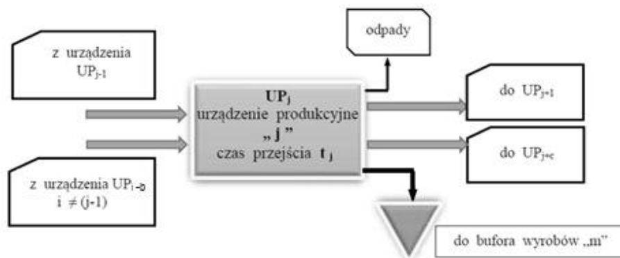
Rys. 2. Schemat przepływu materiału przez urządzenie produkcyjne UP
